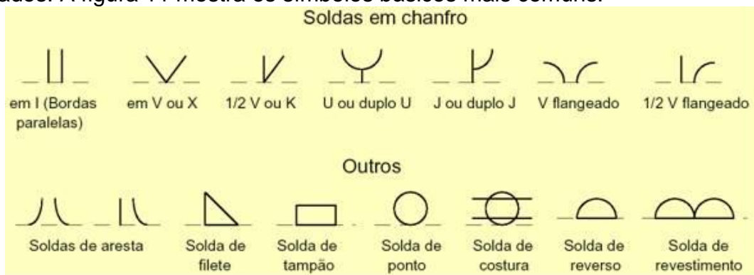
Figura :Símbolos básicos de soldagem
